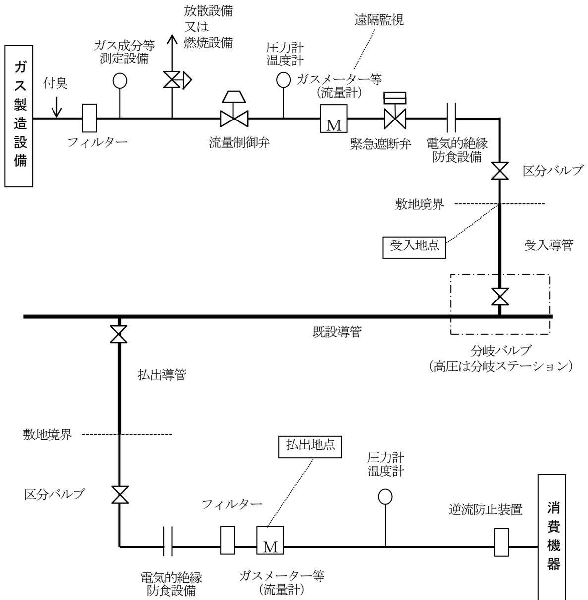
注：上図は概念図として参考に図示したものです。ガス製造形態や受入及び払出地点の位置等による差異が大きい場合、詳細は個別に協議させていただきます。
